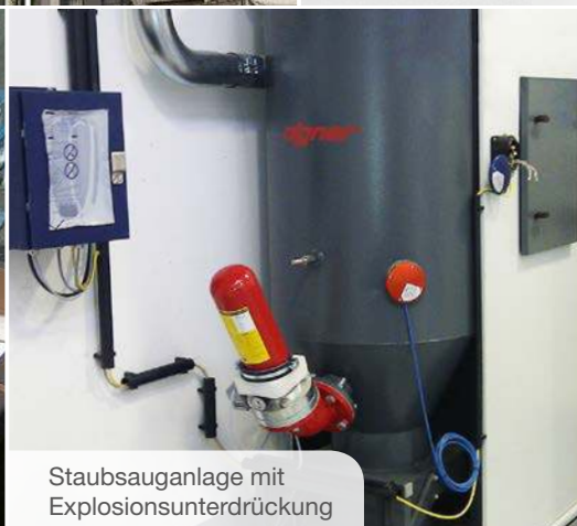
Schweißrauchabsaugung mit Patronenfilter und Brandlöschanlage
