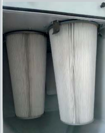
Konische Filtergeometrie für optimale Filterreinigung
